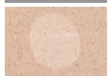
滴下後、時計皿を被せ 3時間後に中性洗剤で洗浄した状態
